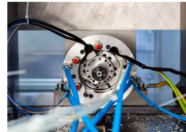
Test eines neuartigen Werkzeugspannsystems für Motorspindeln
