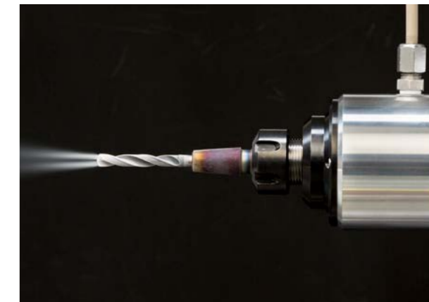
Vorrichtung zur maschinenunabhängigen Zufuhr von kryogenen Kühlmedien für die Bohrbearbeitung
