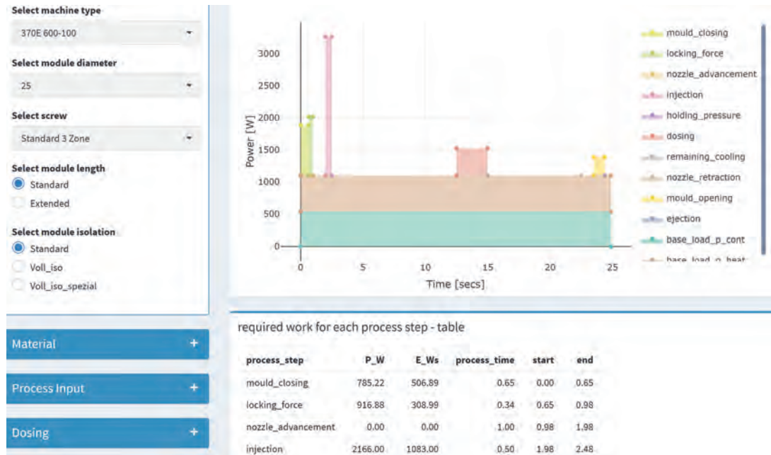
Abb. 11 Ergebnisse einer Simulation des Spritzgießzyklus anhand von eingegebenen Maschinenparametern
