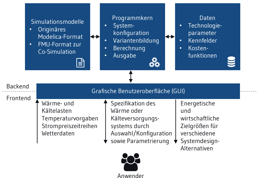
Abb. 3 Schematische Darstellung der zentralen Elemente der Planungsplattform und der Nutzerschnittstellen
