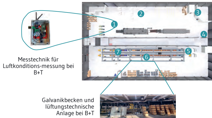
Abb. 6 Technologischer Aufbau zur Luftkonditionsmessung bei der B+T Oberflächentechnik GmbH
