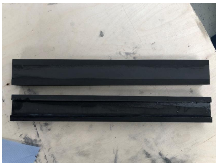
Abbildung 26: Zwischenschritt bei der Verklebung der Rippen für den z-Schlitten
