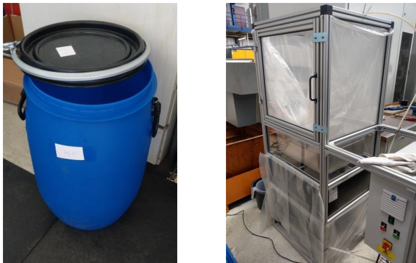
Abbildung 104: Einlagerungsbedingungen – Tauchbad (links) & Nebelkammer (Rechts)
