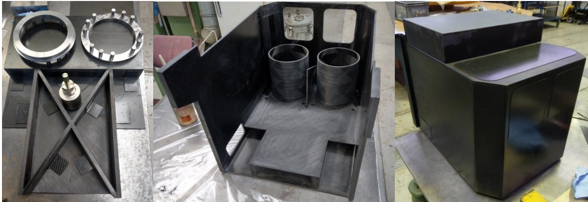
Abbildung 80: Herstellung des CFK-Demonstrators - Bodenplatte (links), Spindelhalterung und äußere Wände (mittig), fertiger Demonstrator (rechts)
