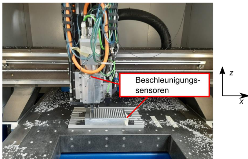
Abbildung 56: Versuchsaufbau zur Ermittlung der Stabilitätskarten
