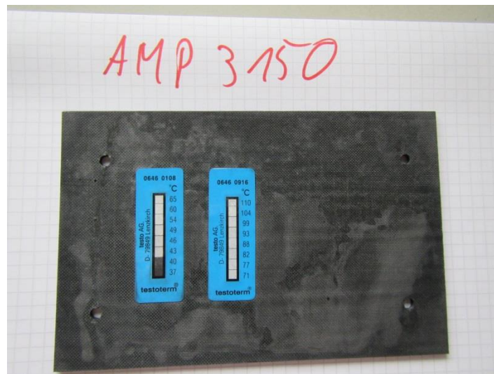
Abbildung 84: Temperaturmessung einer CFK-Platte, die am Stahlbalken befestigt wurde
