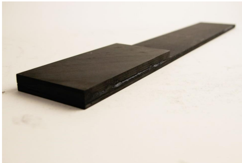
Abbildung 25: Zwischenschritt bei der Verklebung des x-Schlittens. Da eine exakte Dosierung des Klebers händisch nur schwierig möglich und im Vorhinein schwer abzuschätzen ist, kommt es häufig zur Überdosierung. Die Überschüsse müssen dann anschließend entfernt werden
