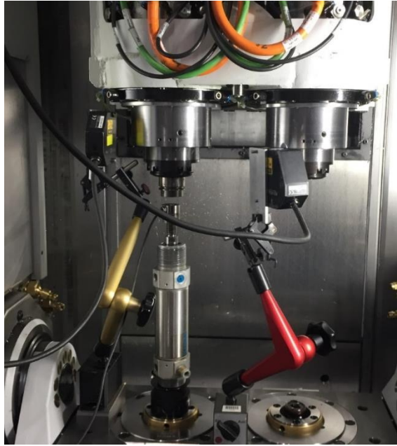
Abbildung 68: Messaufbau zur Steifigkeitsuntersuchung in z-Richtung
