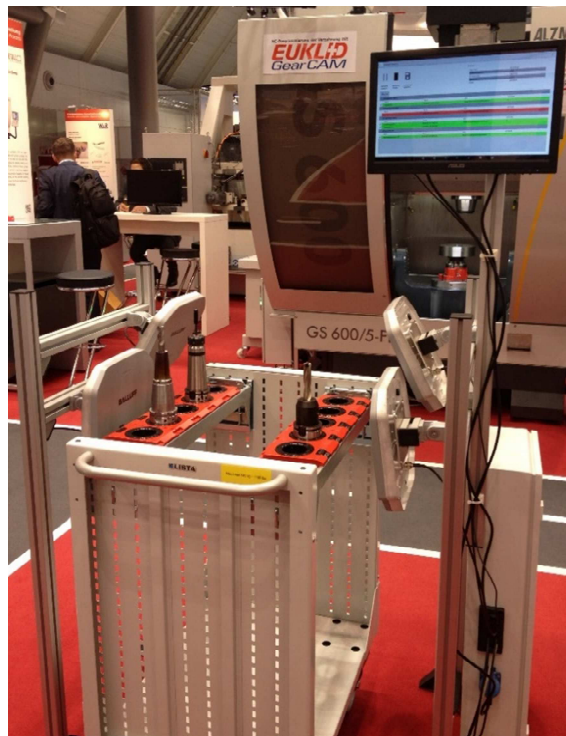
Abbildung 17: Aufbau Portallösung mit Werkzeugwagen
