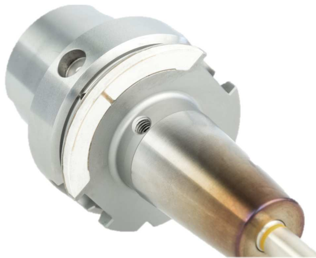
Abbildung 28: Sicht auf störkonturfreie Antenne (weiß)
